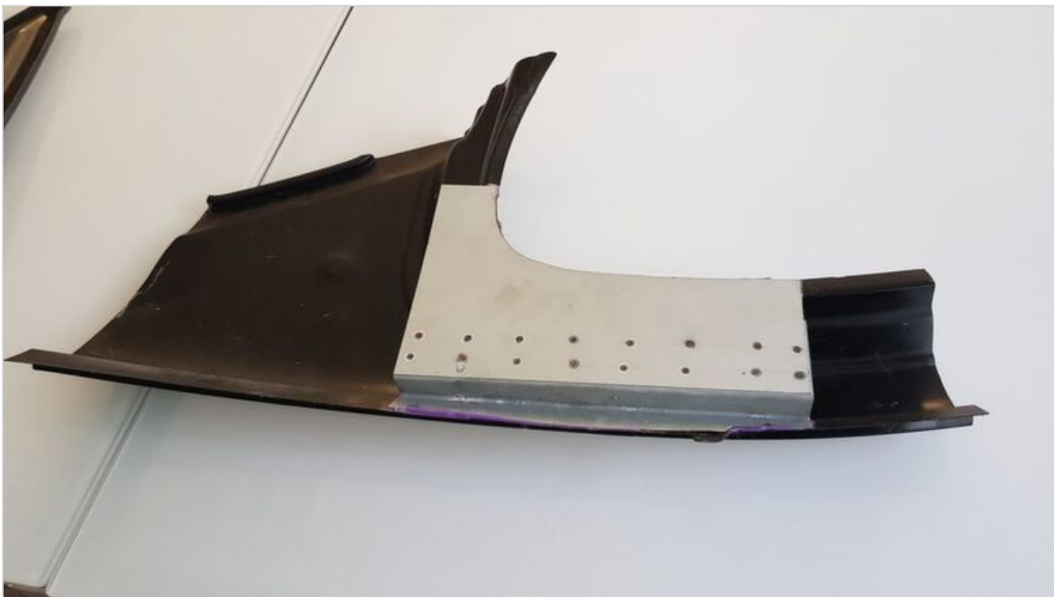
Beispiel für ein geklebtes Bauteil: Die Entwicklung wurde von der Fa. Innotech begleitet und geprüft. (D.Quitter/konstruktionspraxis)
